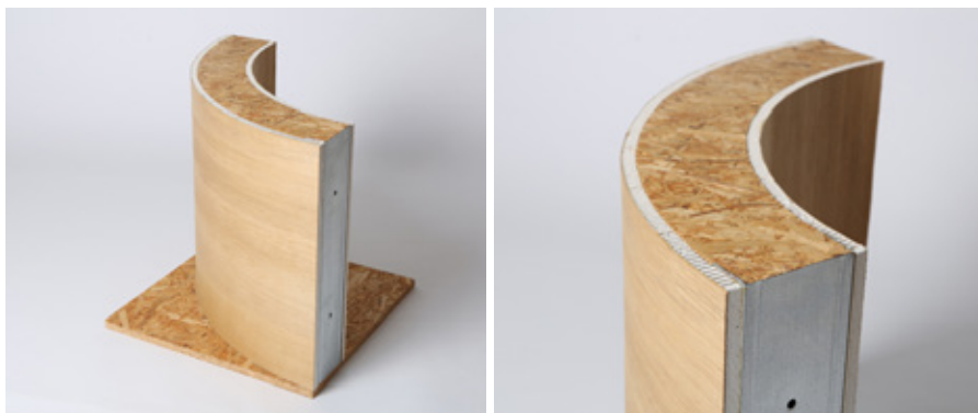
Aplikácia sekundárneho dyhovania na oblej (konkávnej) sadrokartónovej priečke
