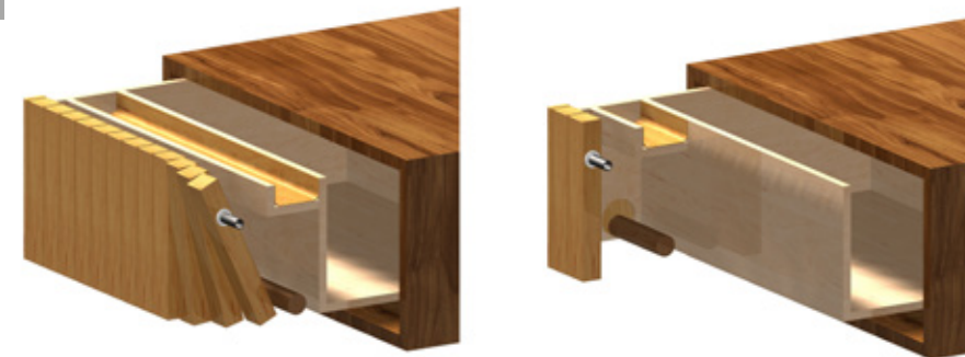
3D pohľad na zvukotvornú časť moderného skriňového nábytku s vysunutou zásuvkou v reze
